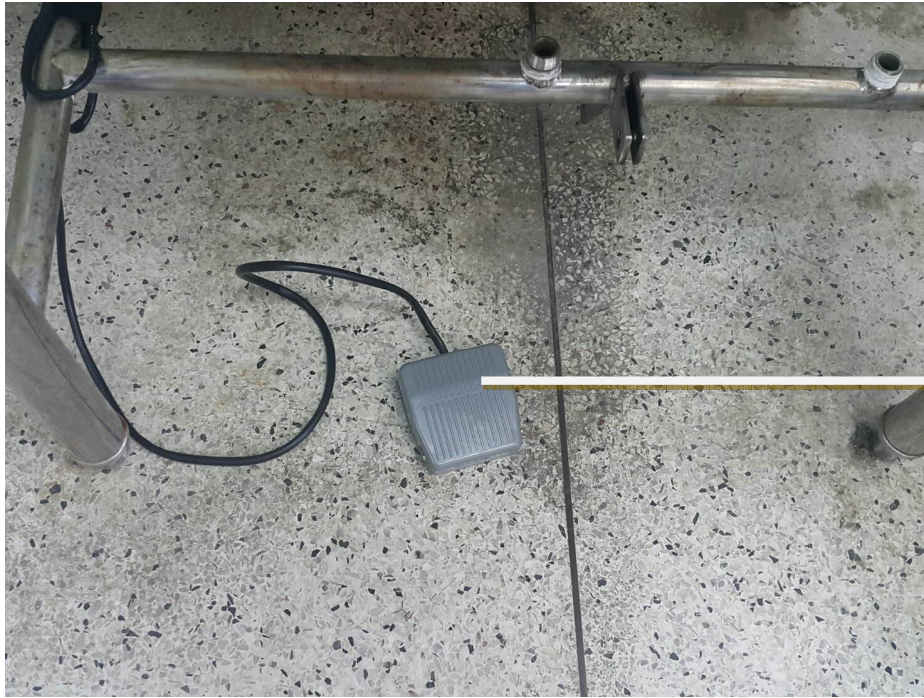
ภาพที่ ๒ หลักการเหยียบเปิดน้ำ เครื่องชูดหินปูนแผนกทันตกรรม
